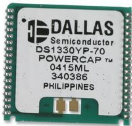
Abbildung 6.1: SRAM mit Anschlüssen zum "Aufsetzen" einer Batterie
